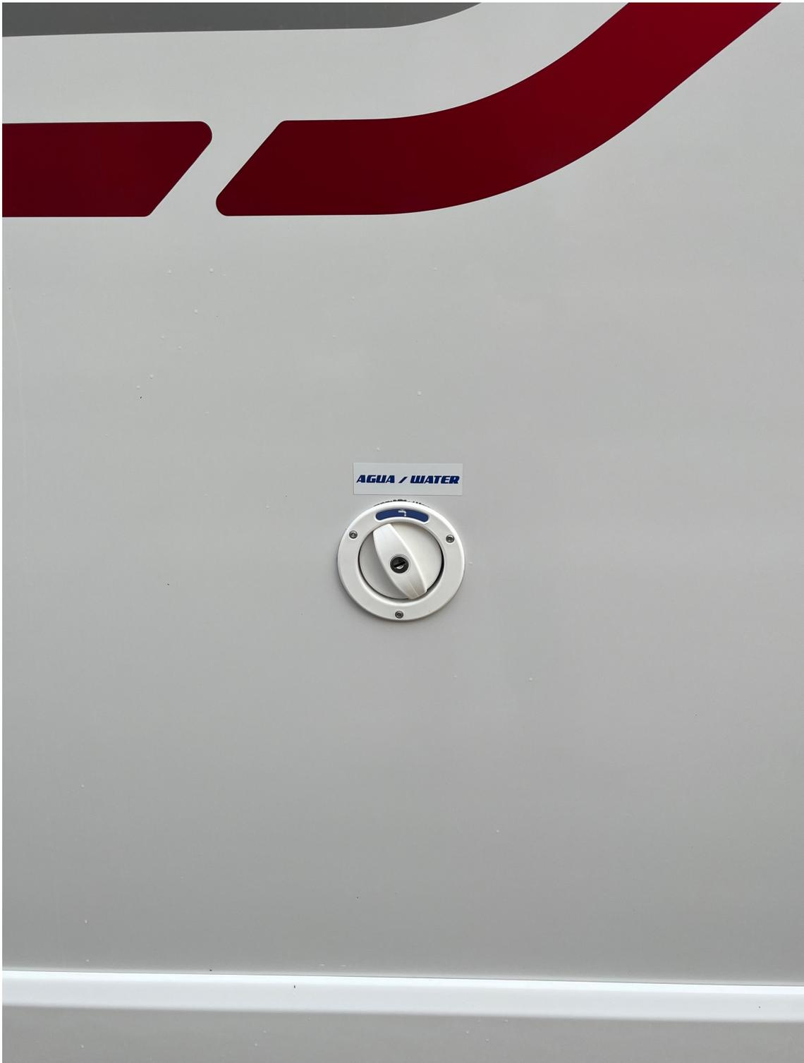
Esta es la boca de llenado del depósito de agua. No confundirla con la del gasoil
